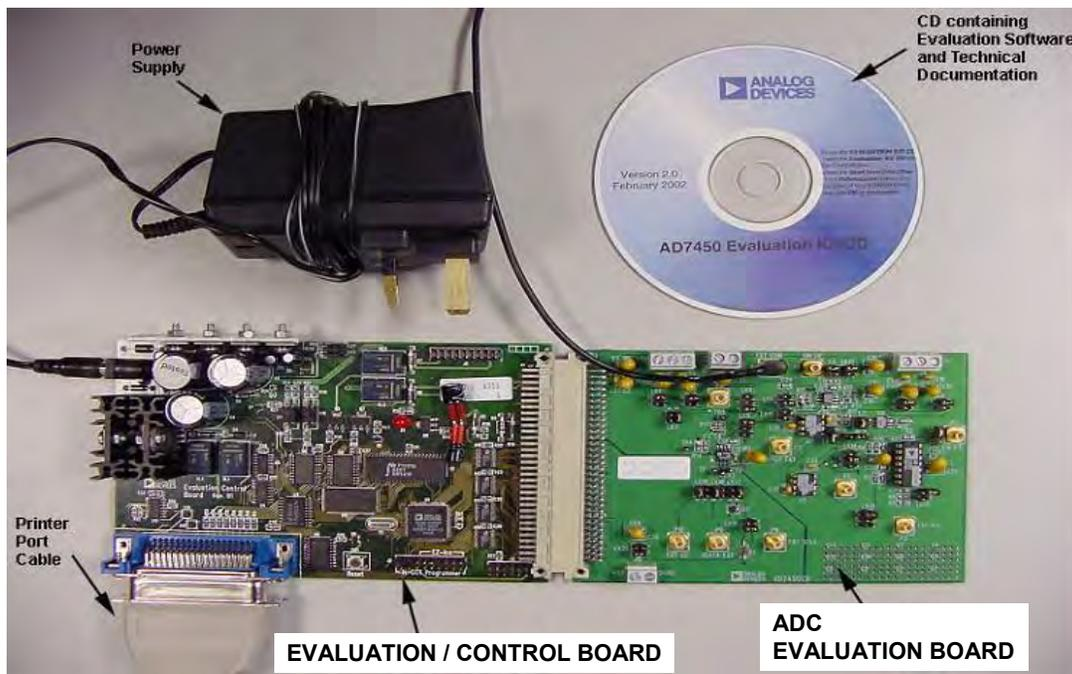
図 13.55: ADC のための評価／制御ボードと ADC 評価用ボード
