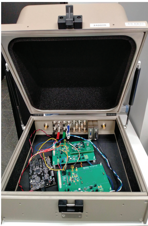
図2. EMFを遮断するための筐体に格納された評価用の回路
