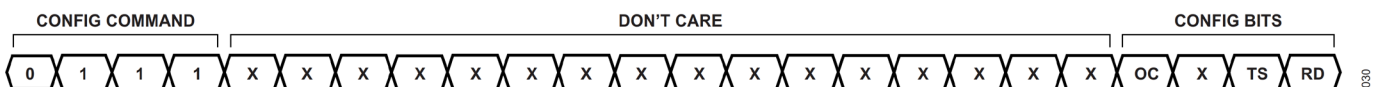
図 33. 設定コマンド構文、オープン回路（OC）検出ディスエーブル、サーマル・シャットダウン（TS）ディスエーブル、リファレンス・ディスエーブル（RD）
