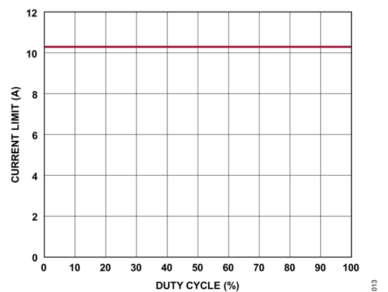
図 13. 下側スイッチの電流制限とデューティ・サイクルの関係
