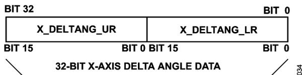
図 48. 角度変化のデータ出力構造
