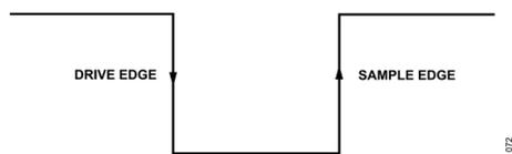
図 68. SPI モード 3、SCLK のエッジ
