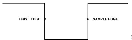
図 71. SPI モード 3、SCLK のエッジ
