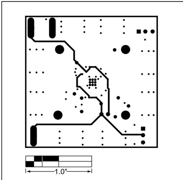
図5. MAX3800EVキットのプリント基板レイアウト
