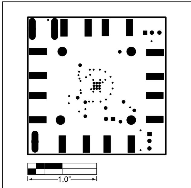
図6. MAX3800EVキットのプリント基板レイアウト
