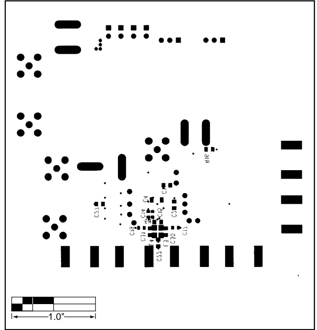
図6. MAX2510 EVキットのプリント基板レイアウト —最下層のシルクスクリーン及びパッドの配置
