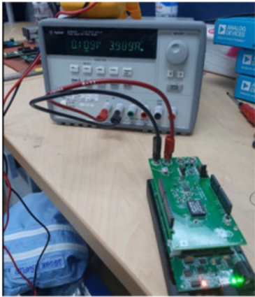
図 18. 電流入力テストのセットアップ写真
