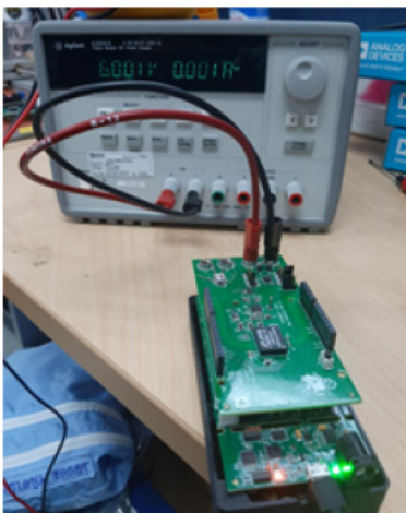
図 14. 電圧入力テストのセットアップ写真
