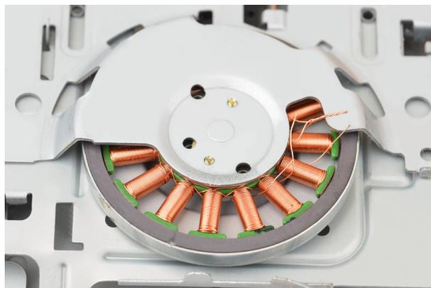
図2. 上部カバーが取り外されたBLDCと磁石ローター
