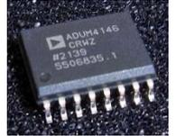
ADuM4146は、ゲート駆動用に両電源あるいは単電源動作が可能で、過電流保護 (DESAT)、ミラークランプ機能 (GATE\_SENSE)、サーマル・シャットダウン (TSD)、VDD1/VDD2 UVLOなどの保護機能も充実しています。\*ブロック図裏面
