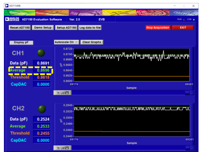
図 12. CDC AD7150 の評価ボード EVAL-AD7150EBZ のソフトウェアで VF-200-F を測定したようす (測定結果が平均 0.8696pF になっている。なお CH2 はデフォルト設定で基板上に形成されている容量を測定している)
