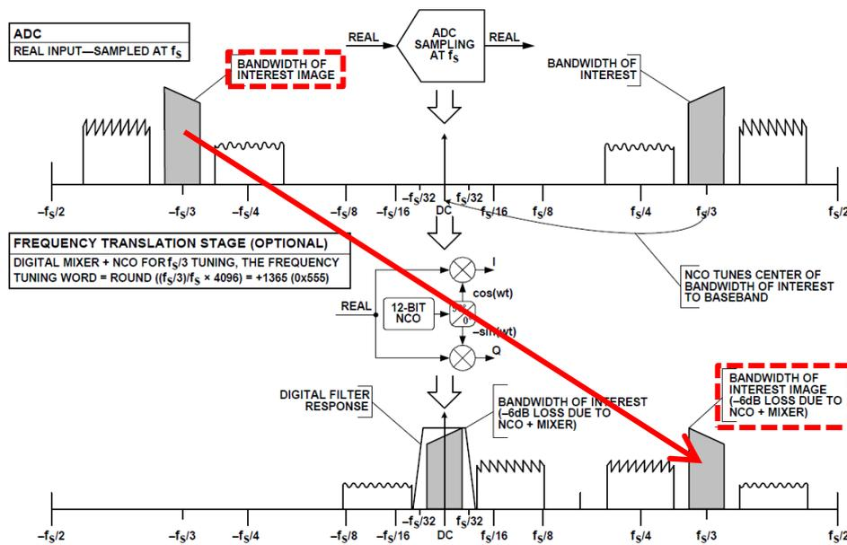
図 8. Fig. 51 で BANDWIDTH OF INTEREST IMAGE が変な周波数に変換されている！
