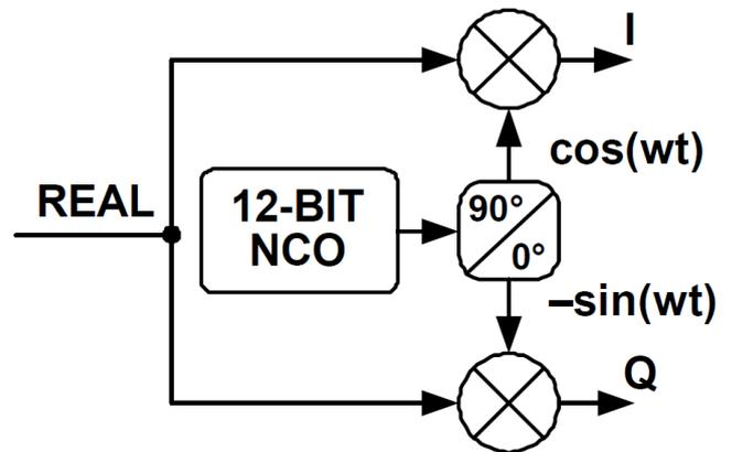
図5. AD9680の複素周波数ミキサ（DDC）。NCOは12bitワード幅になっている
