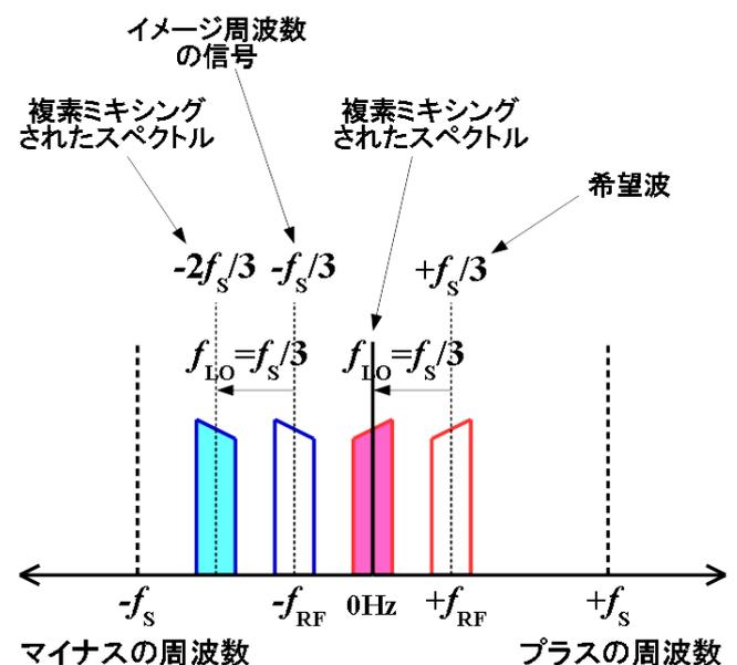
図 9. イメージ周波数の信号が複素ミキシングにより周波数変換されるようす
