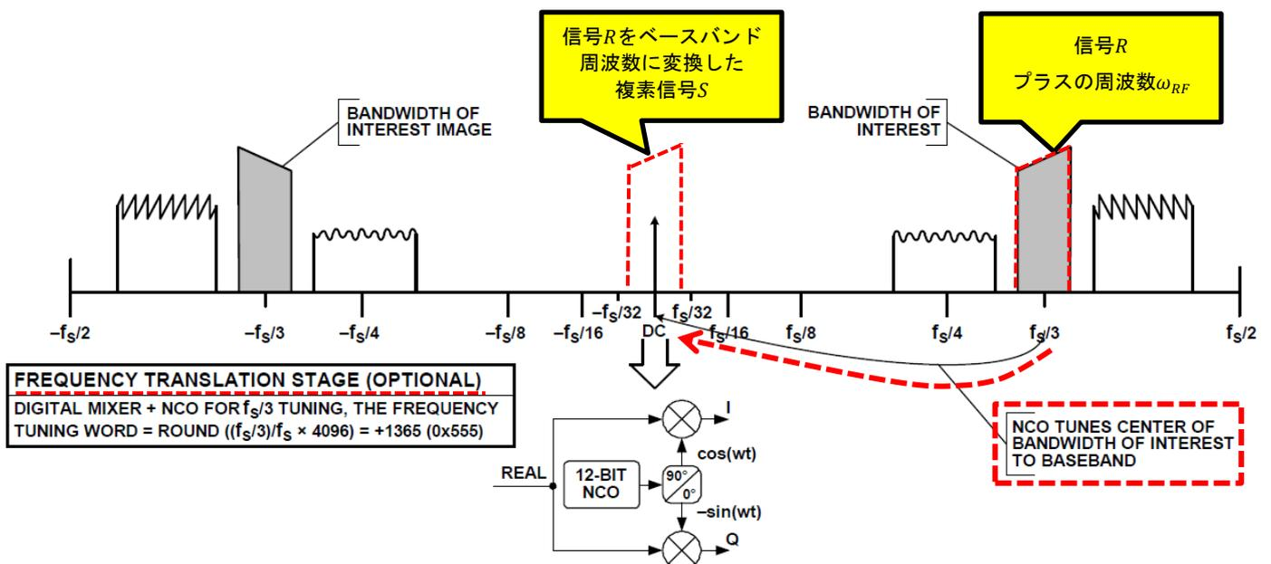
図4. データシート Fig. 51のステップ② FREQUENCY TRANSLATION STAGE（周波数変換段）の説明
