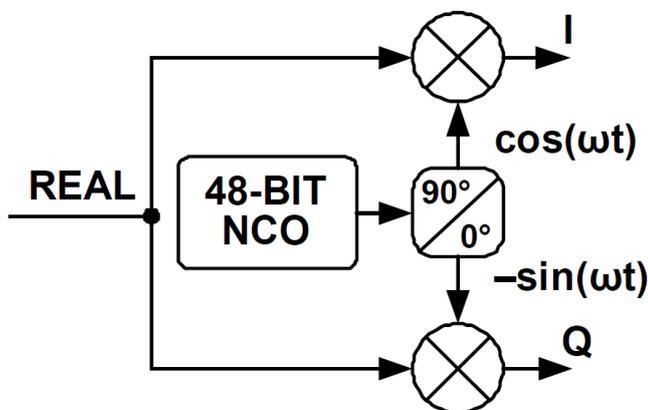
図 11. AD9694 の複素ミキサ (DDC)。サンプリングレートが 500Msps で高速だが、2016 年に発売された最新の製品であるため NCO は 48bit ワード幅になっている
