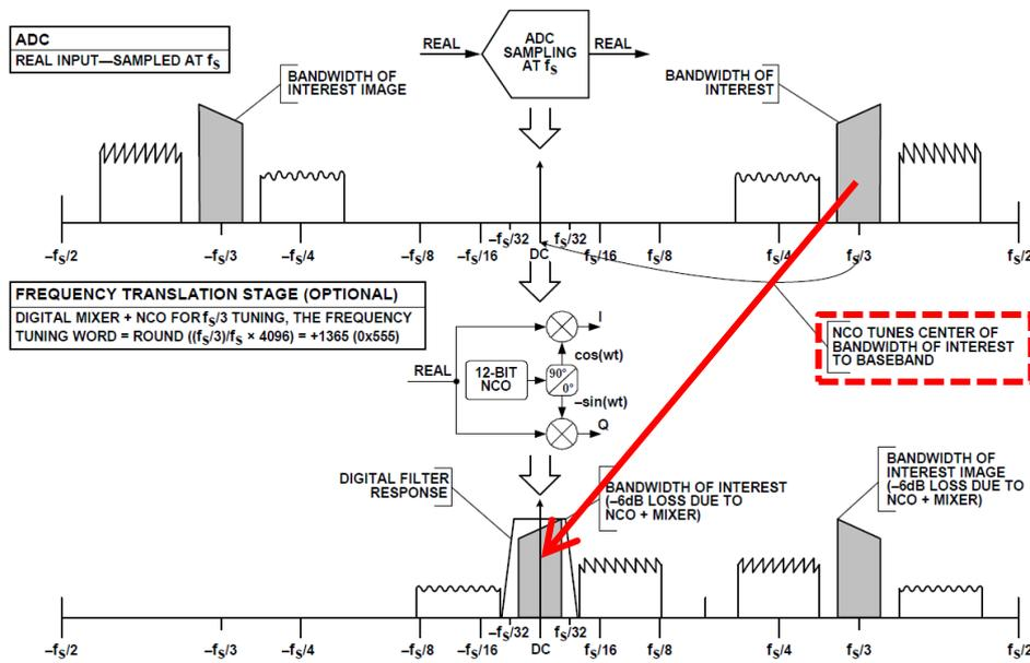
図2. AD9680のデータシートの Fig. 51 に記載されている周波数変換動作の説明
