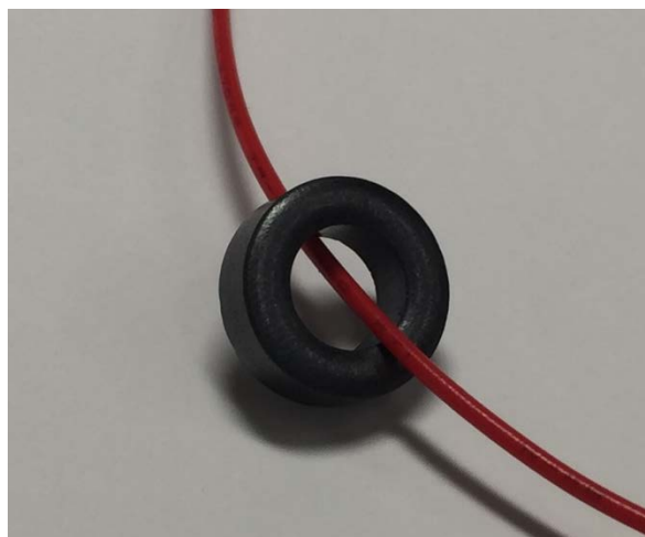
図 1. 実験に使用するトロイダルコア FT-50-43 とそれに 1 回巻きしたようす
