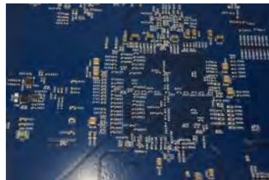
FPGA RXP/RXN pin レジストで計測できない。
