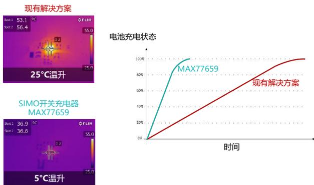
图13. SIMO充电器使充电速度快4倍
