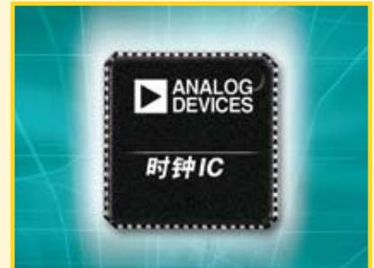
松地将AD9520/2配置为时钟源，以确保系统上电或复位时初始处理功能的同步。而其它同类时钟IC则需要独立的时钟源，在为对系统时钟芯片进行编程时，这些时钟源必须与系统处理器或微控制器进行单独匹配，这会增加时钟设计的器件数量、成本及复杂性。除了片上EEPROM及PLL，AD9520/2还集成了分频器、扇出缓冲器，以及振荡范围为1.4~2.95GHz的压控振荡器(VCO)。PLL/VCO时钟发生电路具有业界领先的相位噪声，同时时钟分配输出通道具有225fs的超低宽带抖动性能。AD9520提供12路差分低压正发射极耦合逻辑(LVPECL)输出，AD9522提供12路差分低压差分信号(LVDS)输出，它们的输出都可分为4组，每组输出都包括1~32分频器与相位延迟。两款器件均可提供24种频率高达250MHz的单端CMOS输出配置。
