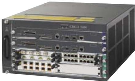
思科公司的7604是一款紧凑型因特网协议/多协议标签交换(IP/MPLS)网络边缘路由器，它使以太网电信服务供应商能够支持广泛的IP视频与三重播放(语音、视频与数据)应用。7604路由器可以处理从OC-3到OC-192、从快速以太网到10Gb以太网的接口。
