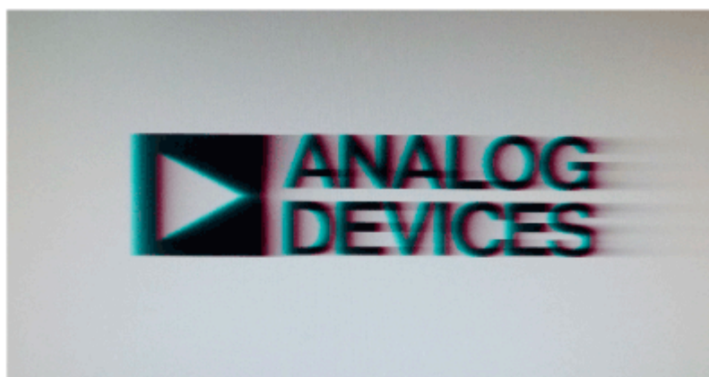
图 21 通过 300 米 Cat-5e 电缆传输，未进行补偿的图像
